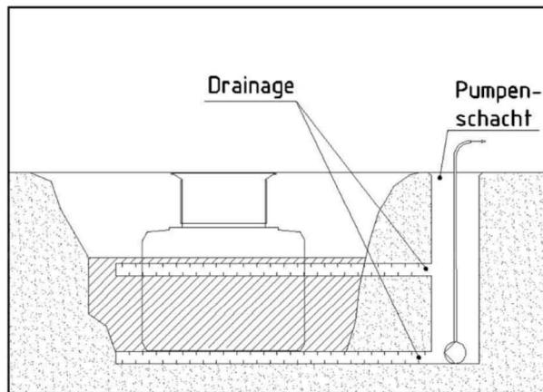
Zpravidla stačí zakrytí nádrží zeminou, aby se predešlo jejich vyplavení. Zakrytí zeminou, které je zapotřebí pro zajištění proti vztlaku, se dosáhne zpravidla tehdy, když je nádrž zeminou (hustota > 1800 kg/m<sup>3</sup>) zakryta až k horní hraně dómu.
